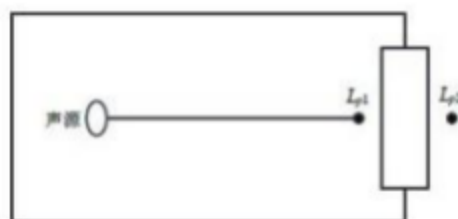
图 4-2 室内声源等效为室外声源示意图
