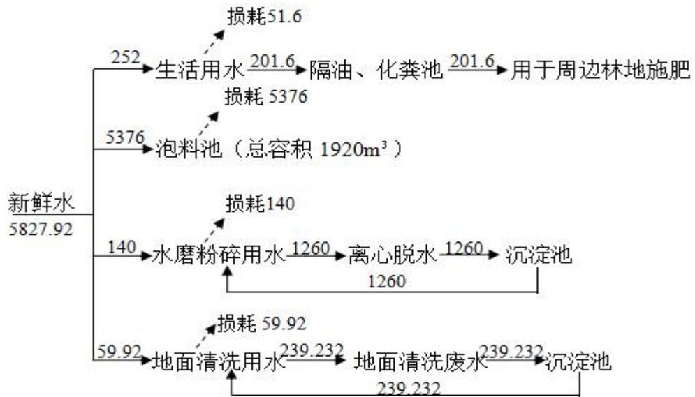
图 2-1 项目给、排水平衡图
