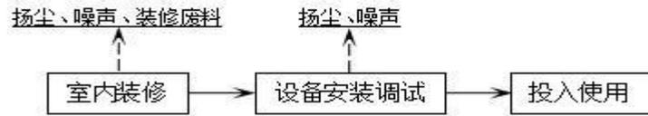
图 2-2 建设项目施工期建设工艺流程及产污环节示意图
