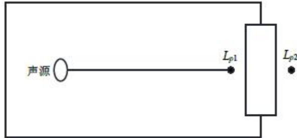
图 4-1 室内声源等效为室外声源示意图
