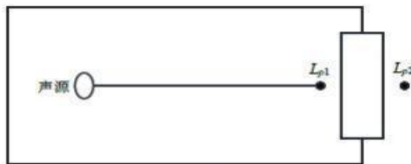
图 4-1 室内声源等效为室外声源示意图
